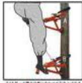
⑥足を引上げて体重を乗せたら、足裏側にも乗せられます。
