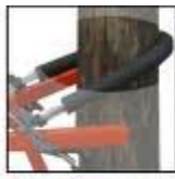
①上下の本木間に付けたワイヤーを張り、ピンポイントで足の間に差し込みます。
