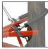
②足先についている押棒を太さの調節をしながら足の間に合わせて調整します。
